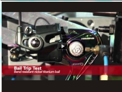
Quantum technológia test preklápača navijákov viac ako 1milión preklopení
