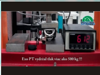
Test prívlačových multiplikátorov EXO pod lisom tlak viac ako 500kg
